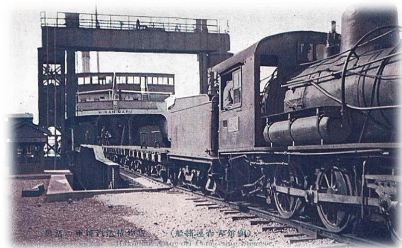
青函連絡船に貨車を積み込む蒸気機関車 (小樽市総合博物館所蔵)
